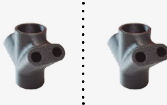
Impresión con 2 extrusores a la vez
