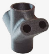
Impresión con un solo extrusor
