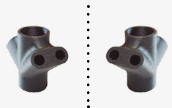
Impresión con 2 extrusores en espejo
